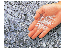
強化ガラスが割れた場合(参考写真)
