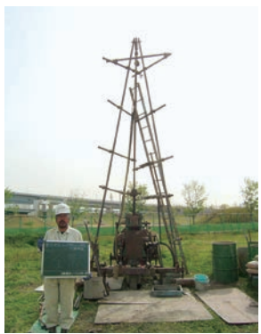
ボーリング調査(参考写真)
