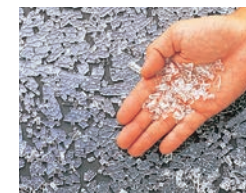
強化ガラスが割れた場合(参考写真)
