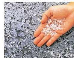
強化ガラスが割れた場合(参考写真)
