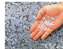
強化ガラスが割れた場合(参考写真)
