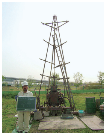
ボーリング調査(参考写真)
